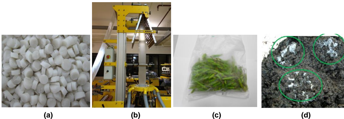
ภาพ (a) เรซินวัสดุผสม TPS/PLA (b) ฟิล์มวัสดุผสม TPS/PLA (c) ถุงพลาสติกจากฟิล์มวัสดุผสม TPS/PLA และ (d) ฟิล์มวัสดุผสม TPS/PLA ภายหลังการฝังกลบในกองปุ๋ยหมักที่อุณหภูมิ ๕๘ องศาเซลเซียส นาน ๖๐ วัน
